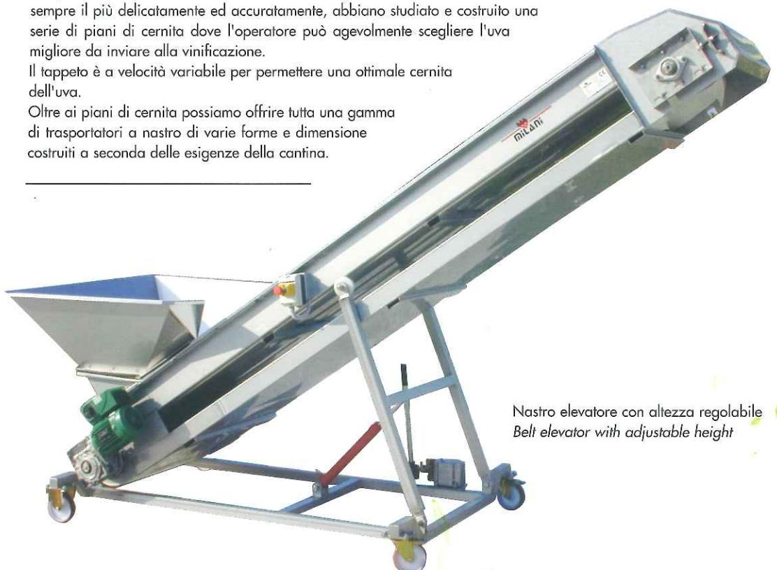
Nastro elevatore con altezza regolabile
